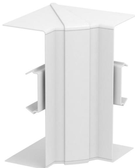
Inneneck-Haubenformteil aus halogenfreiem PC/ABS zur Richtungsänderung von Geräteeinbaukanälen Rapid 80 der Systeme GK, GKH, GS und GA. Die Formteile sind variabel von 85° - 95° verstellbar und einsetzbar für symmetrische und asymmetrische Kanäle.
