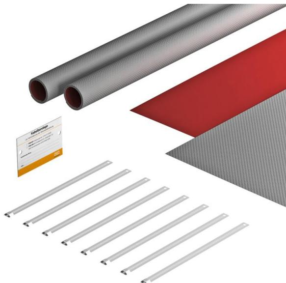
Komplettsset zur Umhüllung von Kabelbündeln oder Kabeltrag-Systemen ohne Deckel zur Verhinderung der Brandweiterleitung. Anwendung im Außenbereich. Die Sets enthalten jeweils 4 Abschnitte der witterungsbeständigen Kabelbandage PYROWRAP® Wet, 8 Metallbandschellen und ein Kennzeichnungsschild. Ausreichend für ca. 2 m Länge.
