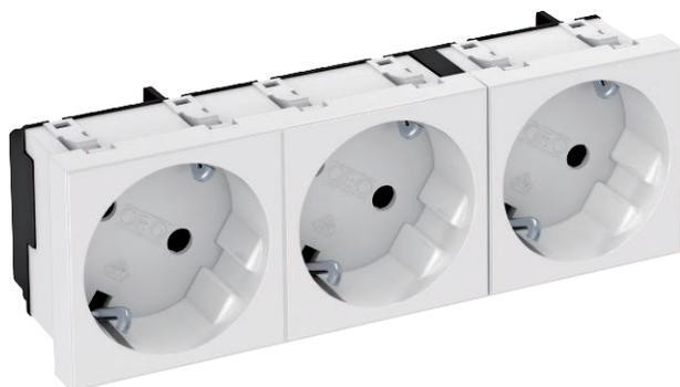
Schutzkontakt-Steckdose 3-fach 33°, mit erhöhtem Berührungsschutz, mit Steckklemmen, 2polig, 16 A, 250 V~, mit Verbindungsklemmen nach IEC 60884-1.
