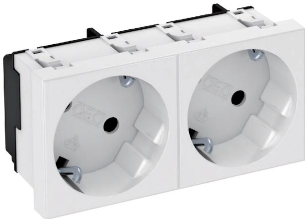
Schutzkontakt-Steckdose 2-fach 33°, mit erhöhtem Berührungsschutz, mit Steckklemmen, 2polig, 16 A, 250 V~, mit Verbindungsklemmen nach IEC 60884-1.
