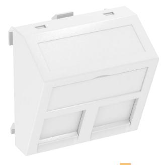
Datentechnikträger mit schrägem Auslass und Verschlussschieber zur Aufnahme von zwei Datentechnik-Anschlussmodulen mit RJ45-Buchse. Die Rastbefestigung eignet sich für den waagerechten und senkrechten Einbau in die Systemumgebung. Typ RM hat eine spezielle Modulaufnahme und ist für eine indirekte Befestigung der Daten-Anschlussmodule in der Montageöffnung ausgelegt.
