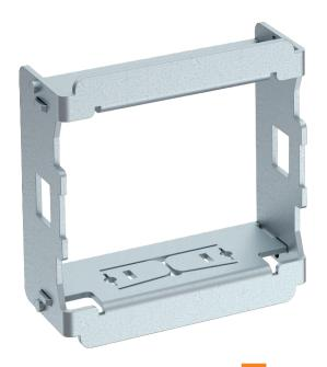
Der Adapter ermöglicht einen um  $90^\circ$  gedrehten Schaltereinbau in z.B. Installationssäulen mit 45er-Spur oder Rapid 45. Passend für alle Schalter und Taster in 1 Modulbreite (45 x 45 mm).
