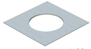
Montagedeckel für Unterflur-Zug- und -Abzweigdosen vom Typ UZD350-3 zum Einbau einer Einbaueinheit der Nenngröße R4. Einbauöffnung 3 mm vertieft zum nachträglichen Blindverschluss mit Deckelblindplatte.
