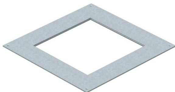
Montagedeckel für Unterflur-Zug- und -Abzweigdosens vom Typ UZD250-3/4 zum Einbau einer Einbaueinheit der Nenngröße 9. Einbauöffnung 3 mm vertieft zum nachträglichen Blindverschluss mit Deckelblindplatte.
