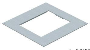
Montagedeckel für Unterflur-Zug- und -Abzweigdosen vom Typ UZD250-3/4 zum Einbau einer Einbaueinheit der Nenngröße 6. Einbauöffnung 3 mm vertieft zum nachträglichen Blindverschluss mit Deckelblindplatte.
