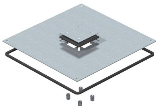
Montagedeckel für Unterflur-Zug- und -Abzweigdosens vom Typ UZD350-3/4 zum Aufbau eines Telitanks. Einbauöffnung 3 mm vertieft zum nachträglichen Blindverschluss mit Deckelblindplatte.
