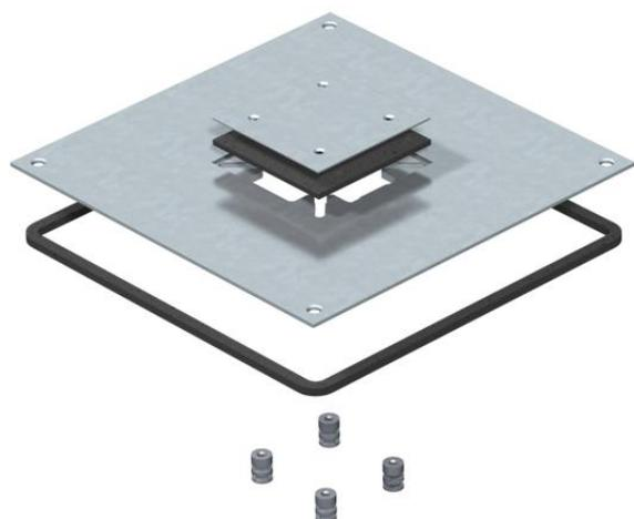
Montagedeckel für Unterflur-Zug- und -Abzweigdosens vom Typ UZD250-3/4 zum Aufbau eines Telitanks. Einbauöffnung 3 mm vertieft zum nachträglichen Blindverschluss mit Deckelblindplatte.
