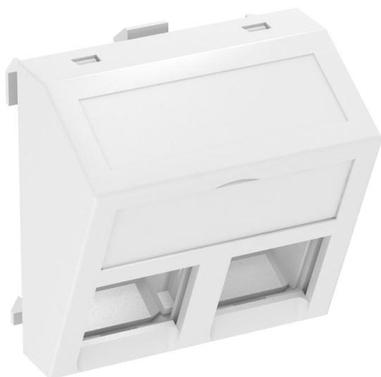
Datentechnikträger mit schrägem Auslass, ohne Verschlusschieber, zur Aufnahme von zwei Datentechnik-Anschlussmodulen mit RJ45-Buchse. Die Rastbefestigung eignet sich für den waagerechten und senkrechten Einbau in die Systemumgebung. Typ C hat eine Montageöffnung von 19,30 X 14,80 mm und ist für die direkte Befestigung der Daten-Anschlussmodule in der Montageöffnung ausgelegt.
