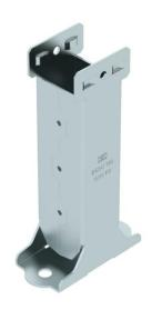
Unterteil der symmetrischen Bodenstütze für das BKRS-System, passend für Traverse Typ BSST 100. Einsetzbar für begehbare Kabelrinnen Breite 100 mm. Mit Gewindedurchzügen zum Montieren von Anschlussbauteilen, z. B. Rohrklemmen, sowie mit Langlöchern für Bodenmontage bis M10. Befestigungsmaterial muss separat bestellt werden.
