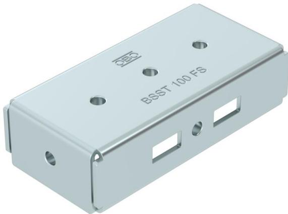
Traverse der symmetrischen Bodenstütze für das BKRS-System, passend für Unterteil Typ BSSU 190 1010. Einsetzbar für begehbare Kabelrinnen Breite 100 mm. Mit Gewindedurchzügen zum spanlosen Montieren von Kabelrinnen. Befestigung an Unterteil mit 4x FKS Flachkopfschraube M6. Befestigungsmaterial muss separat bestellt werden.
