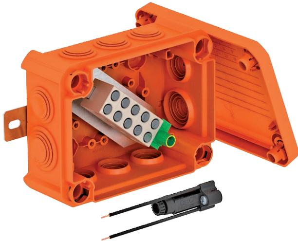
Halogenfreier Kabelabzweigkasten mit vormontierten, weichen Einsteckdichtungen, zugelassen für den elektrischen Funktionserhalt gemäß DIN 4102 Teil 12. Funktionserhaltklassen E30 bis E90.
