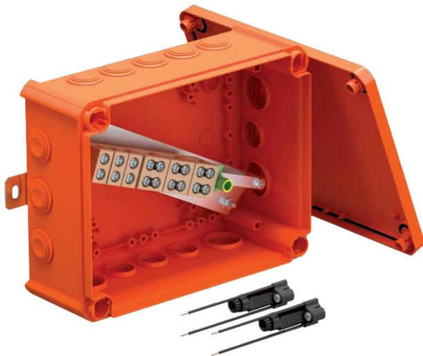
Kabelabzweigkasten mit zwei Sicherungshaltern und weichen Einsteckdichtungen. Ausreichender Verdrahtungsraum durch diagonal angeordnete Anschlusseinheit mit komplett vormontierten hohtemperaturbeständigen Keramikklemmen. Grün-gelb gekennzeichnete Schutzleiterklemme. Befestigung an gut zugänglichen Außenlaschen. Zugelassen für Kabelanlagen mit elektrischem Funktionserhalt nach DIN 4102 Teil 12 mit den Klassen E30, E60 und E90. Keramikklemmen wurden nach DIN EN 60998-2-1:2004 geprüft.
