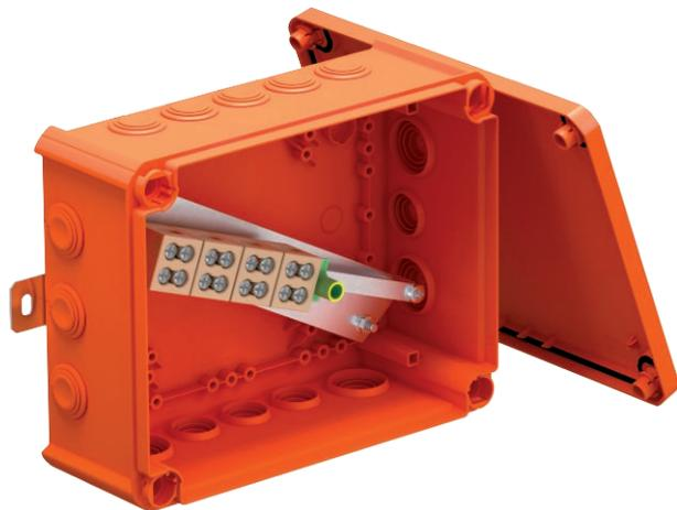
Kabelabzweigkasten mit keramischen Doppelklemmen und weichen Einsteckdichtungen. Ausreichender Verdrahtungsraum durch diagonal angeordnete Anschlusseinheit mit komplett vormontierten hochtemperaturbeständigen Keramikklemmen. Grün-gelb gekennzeichnete Schutzleiterklemme. Befestigung an gut zugänglichen Außenlaschen. Zugelassen für Kabelanlagen mit elektrischem Funktionserhalt nach DIN 4102 Teil 12 mit den Klassen E30, E60 und E90. Keramikklemmen wurden nach DIN EN 60998-2-1:2004 geprüft.
