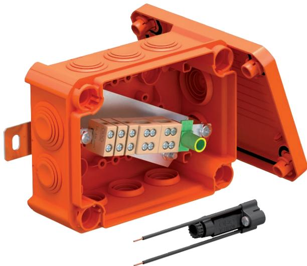
Kabelabzweigkasten mit einem Sicherungshalter und weichen Einsteckdichtungen. Ausreichender Verdrahtungsraum durch diagonal angeordnete Anschlusseinheit mit komplett vormontierten hochtemperaturbeständigen Keramikklemmen. Grün-gelb gekennzeichnete Schutzleiterklemme. Befestigung an gut zugänglichen Außenlaschen. Zugelassen für Kabelanlagen mit elektrischem Funktionserhalt nach DIN 4102 Teil 12 mit den Klassen E30, E60 und E90. Keramikklemmen wurden nach DIN EN 60998-2-1:2004 geprüft.
