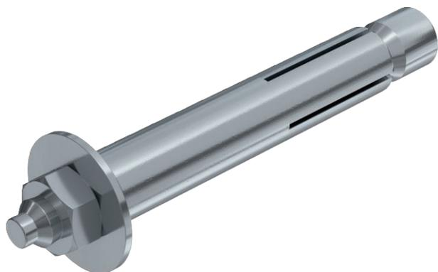
Brandschutztechnisch geprüfter und zugelassener Stahlspreizdübel für den Einsatz in Porenbeton. Ausführung mit Außengewinde. Für eine Brandbelastung bis zu 120 Minuten geeignet, Lastwerte der allgemeinen bauaufsichtlichen Zulassung entnehmen (gilt für Porenbeton der Festigkeitsklassen min. 3,3). Für die Montage ist ein Setzwerkzeug erforderlich.
