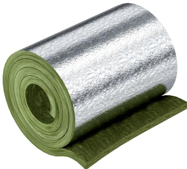
Mineralfasermatten mit Aluminiumkaschierung für Streckenisolierungen für Kupfer- und Stahlrohren. Befestigung der Streckenisolierung mit Wickeldraht und sichern der Stoßfugen mit Aluminiumklebeband.
