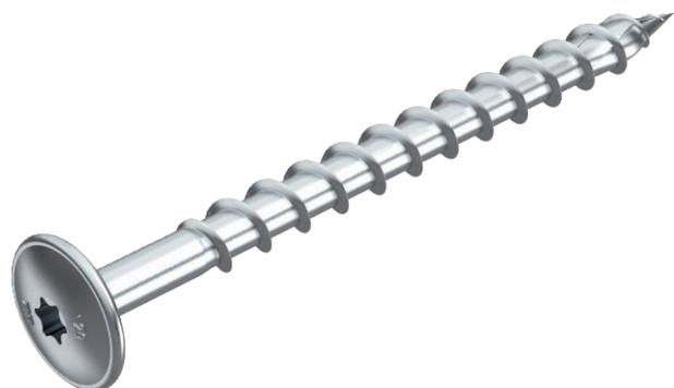
Selbstbohrende Holzschraube zur brandsicheren Befestigung von Kabelanlagen für den Funktionserhalt nach DIN 4102 Teil 12 an tragenden Holzbauteilen. Die Tellerkopfform ermöglicht den Einbau ohne zusätzliche Unterlegscheibe.
