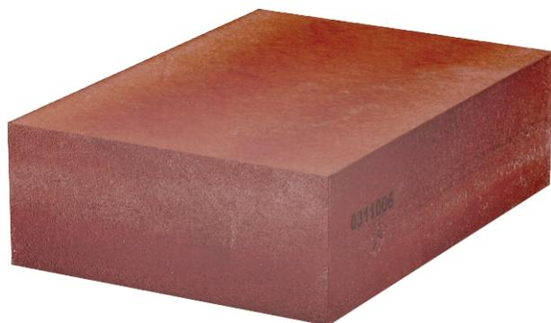
Weicher, dauerelastischer Schaumblock für Kabel- und Kombiabschottungen. Längs- und Quereinbau zur Erreichung unterschiedlicher Feuerwiderstandsklassen möglich. Kombinierbar mit dem 2-Komponenten Brandschutzschaum PYROSIT® NG. Einsetzbar in massiven Decken und Wänden sowie in leichten Trennwänden und zugelassen für viele Installationen. CE-gekennzeichnetes Bauprodukt gemäß ETA-15/0803 für Anwendungen mit Feuerwiderstandsdauern bis zu 120 Minuten.
