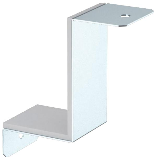
Bügel mit integrierter Dichtung für BSKM 0711, zum rauchdichten Verschluss der Kanalstoßstellen bei Eckmontage ohne Abstand des Kanals zur Decke oder Wand.
