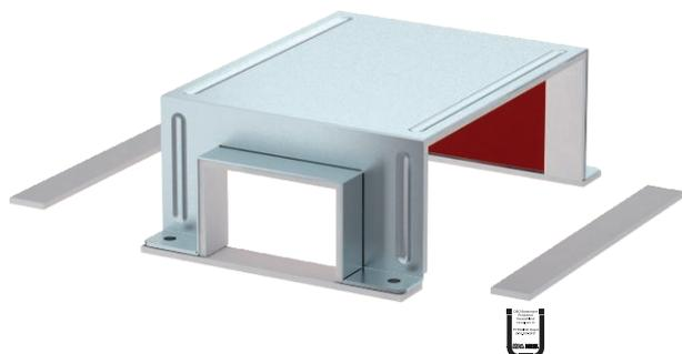
Haube zur Abdeckung einer T-förmigen Anordnung von drei zueinander laufenden Kanälen. Gerade Strecke zweimal BSKM 1025, Abzweig reduziert auf BSKM 0711. Inklusive eingeklebter Dichtungen zum Abdichten der Fugen und losen Dichtungen bei Kombination mit Gegenplatte, sowie Schrauben für den Potentialausgleich.
