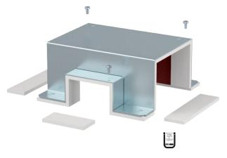
Haube zur Abdeckung einer T-förmigen Anordnung von drei zueinander laufenden Kanalenden. Gerade Strecke zweimal BSKM 0711, Abzweig reduziert auf BSKM 0407. Inklusive eingeklebter Dichtungen zum Abdichten der Fugen und losen Dichtungen bei Kombination mit Gegenplatte, sowie Schrauben für den Potentialausgleich.
