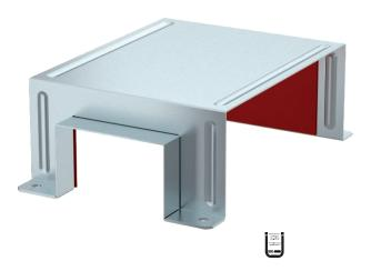
Haube zur Abdeckung einer T-förmigen Anordnung von drei zueinander laufenden Kanalenden. Gerade Strecke zweimal BSKM 1025, Abzweig reduziert auf BSKM 0407. Inklusive eingeklebter Dichtungen zum Abdichten der Fugen und losen Dichtungen bei Kombination mit Gegenplatte, sowie Schrauben für den Potentialausgleich.
