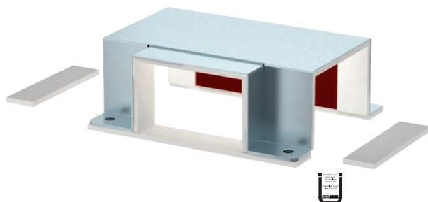
Formteil-Haube zur Abdeckung einer T-förmigen Anordnung von drei zueinander laufenden Kanälen BSKM 0711. Inklusive eingeklebter Dichtungen zum Abdichten der Fugen und losen Dichtungen bei Kombination mit Gegenplatte, sowie Schrauben für den Potentialausgleich.
