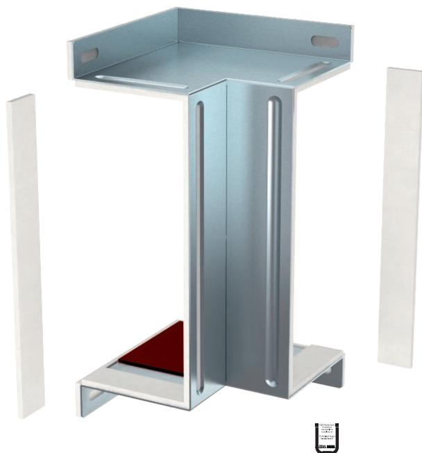
Formteil-Haube zur Abdeckung von zwei Kanalenden BSKM 1025 als Inneneck bei direkter Wand- und Deckenmontage. Inklusive eingeklebter Dichtungen zum Abdichten der Fugen und losen Dichtungen bei Kombination mit Gegenplatte, sowie Schrauben für den Potentialausgleich.
