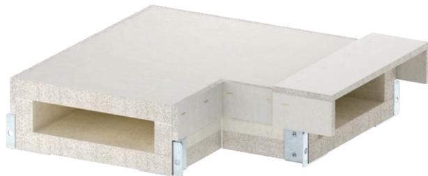
Bogen 90° für BSKH I90/E30, gem. DIN 4102 Teil 11 und Teil 12, zur Installation auf OBO-Montagesystemen. Formteile müssen durch zusätzliche Ausleger unterstützt werden. Inkl. fertig montierter Verbinder an beiden Kanallenden, 3 x 1 m selbstklebender Dichtungstreifen und Verbindungsschrauben.
