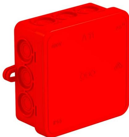
Schutzart IP55, Nennspannung 690 V, Nennquerschnitt 2,5 mm<sup>2</sup>, 12 Einführungen für Kabeldurchmesser 5-14 mm. Klemmdeckel.
