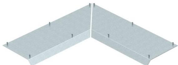
Blinddeckel 2-teilig zum Abdecken des Innenecks eines Aufflurkanals, passend zu den Kanalunterteilen AIK/U inkl. 10 Befestigungsschrauben. Der Kanaldeckel wird in den Al-Seitenprofilen des Kanalunterteils festgeschraubt. Die Deckelschräge überragt das Kanalunterteil im 45°-Winkel.
