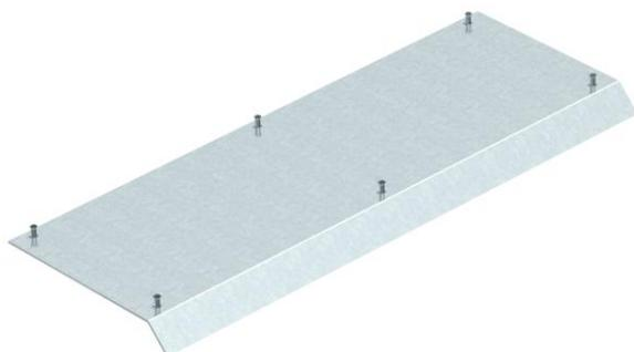
Aufflur-Blinddeckel zum Abdecken des Aufboden-Installationskanals AIK, passend zu den Kanalunterteilen AIK/U. Der Kanaldeckel wird in den AI-Seitenprofilen des Kanalunterteils festgeschraubt. Die Deckelschräge überragt das Kanalunterteil im 45°-Winkel.
