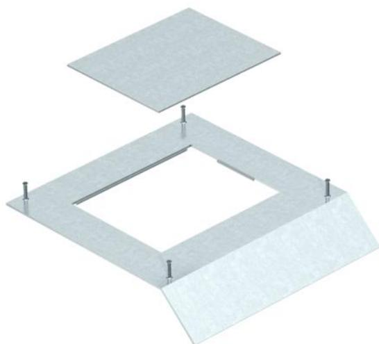
Geräteinsatzdeckel für Kanalunterteil AIK/U für den Einbau eines Geräteinsatzes der Nenngröße 6. Montageöffnung durch 2-mm-Alu-Blindplatte verschlossen. Der Kanaldeckel wird in den Al-Seitenprofilen des Kanalunterteils festgeschraubt. Die Deckelschräge überragt das Kanalunterteil im 45°-Winkel.
