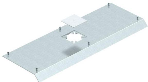
Geräteanschlussdeckel für Kanalunterteil AIK/U für den Aufbau eines Telitanks. Der Kanaldeckel wird in den Al-Seitenprofilen des Kanalunterteils festgeschraubt. Die Deckelschräge überragt das Kanalunterteil im 45°-Winkel.
