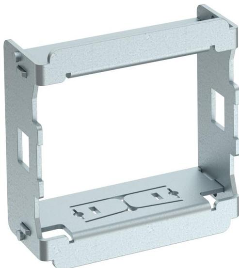
Der Adapter ermöglicht einen um 90° gedrehten Schaltereinbau in z.B. Installationsäulen mit 45er-Spur oder Rapid 45. Passend für alle Schalter und Taster in 1 Modulbreite (45 x 45 mm).
