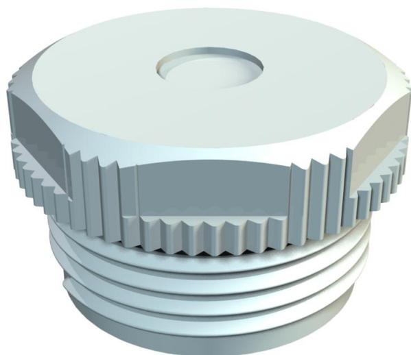
Mit Durchstoßmembrane, hierbei ist die Öffnung D vorgeprägt, aber zunächst verschlossen. Würgedichtung zum Einschrauben in PG-Gewinde nach DIN 40430. Mit selbstdichtendem Konus am Gewindeende, daher kein Anschlussgewindedichtring erforderlich. Erreichbare Schutzart bei sorgfältiger Montage IP54. Mit Durchstoßmembrane, hierbei ist die Öffnung D vorgeprägt, aber zunächst verschlossen.
