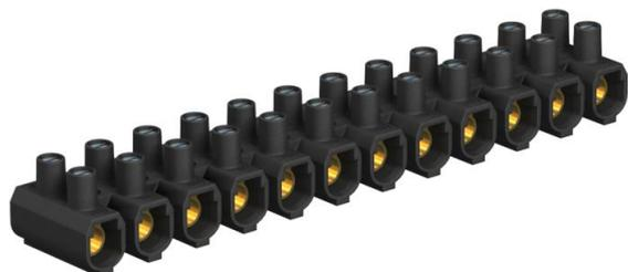
Geprüft nach EN 60998. Klemmen Messing, Schrauben Stahl, galvanisch verzinkt, 12-polige, in Einzelklemmen abtrennbare Leisten. Schrauben hochgedreht, unverlierbar. Max. zulässige Umgebungstemperatur gemäß EN 60998: -5 bis +80 °C. Nennquerschnitt 35 ± mm<sup>2</sup> Nennspannung 750 V Nennstrom 125 A Max. klemmbar je Seite: 35 mm<sup>2</sup> mehrdrähtig oder 25 mm<sup>2</sup> feindrähtig.
