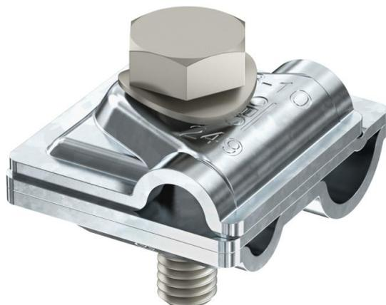
Schnellverbinder zum Erstellen von T-, Kreuz- und Parallel-Verbindungen. Montage mit Schraube M10 x 40 aus rostfreiem Edelstahl. Passend für Bewehrungsstäbe  $\varnothing$  6-16 mm und Rundleiter  $\varnothing$  8-10 mm. Entspricht den Anforderungen nach VDE 0185-305 (IEC 62305).
