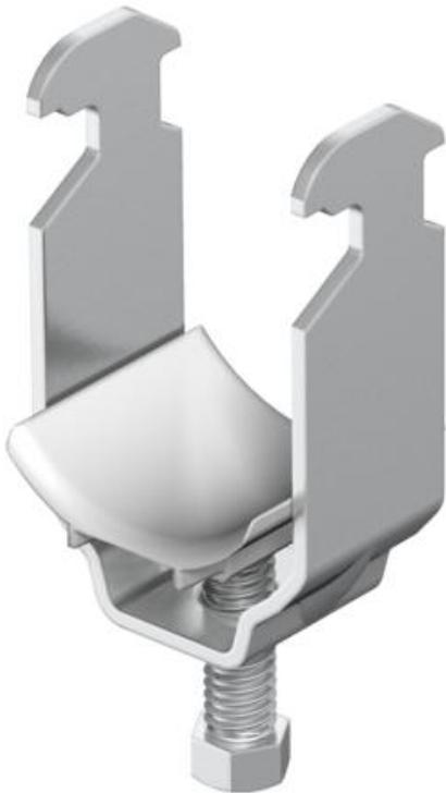
Passend zu allen C-Proflschienen mit 16 - 17 mm Schlitzweite; Schelle und Schraube aus Aluminium ALMg 3, Druckwanne aus Polypropylen, halogenfrei, lichtgrau RAL 7035.
