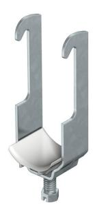
Passend zu Winkeleisen mit 40 mm Schenkellänge. Schelle und Schraube aus tauchfeuerverzinktem Stahl. Druckwanne aus Polypropylen, halogenfrei, Farbe Lichtgrau RAL 7035.
