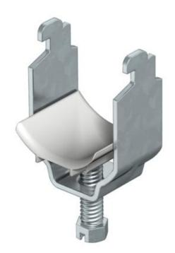
Passend zu allen C-Profilschienen mit 11 - 12 mm Schlitzweite, mindestens 6,5 mm lichter Innenhöhe und mindestens 18,5 mm lichter Innenbreite. Schelle und Schraube aus tauchfeuerverzinktem Stahl. Druckwanne aus Polypropylen, Farbe Lichtgrau RAL 7035, halogenfrei.
