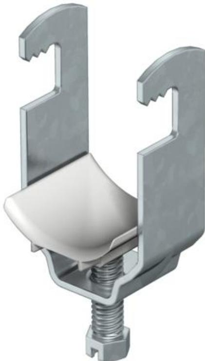
Passend zu Flach-, Winkel- und U-Eisen von 4 - 12 mm Materialstärke. Schelle und Schraube aus tauchfeuerverzinktem Stahl. Druckwanne aus Polypropylen, halogenfrei, Farbe Lichtgrau RAL 7035. Ausführung mit Anschweiß- und/oder Kontermutter für Einsatz unter erschwerten Bedingungen sowie für Rüttelsicherheit auf Anfrage!
