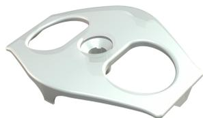
Ohne Nagel, zum Nachrüsten von Ø 3 mm und 3,5 mm Stahl Nagel zur Fixierung von Leitungen in Mauer Schlitz und auf Mauerwerk für 1 bzw. 2 Leitungen NYM 3 x 1,5/2,5 mm<sup>2</sup> oder 1 bzw. 2 Leitungen NYM 5 x 1,5/2,5 mm<sup>2</sup>.
