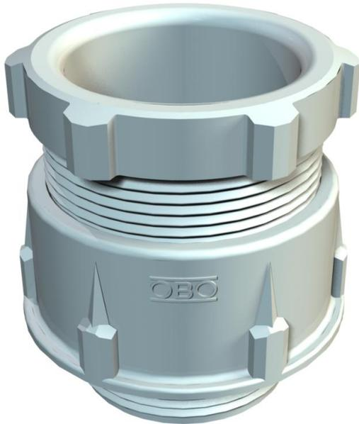
Standard-Kabelverschraubung, Form A nach DIN 46320 mit einfachem Dichtring aus NR/SBR mit metrischem Anschlussgewinde nach IEC 423.
