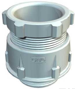
Standard-Kabelverschraubung, Form A nach DIN 46320 mit einfachem Dichtring aus NR/SBR mit metrischem Anschlussgewinde nach IEC 423. Schutzar: mit Anschlussgewinde-Dichtring IP65, ohne Anschlussgewinde-Dicht-
