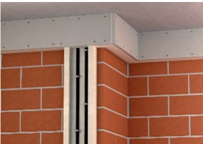
Kabelbefestigung bei senkrechter Kanalmontage mit Schellen.
