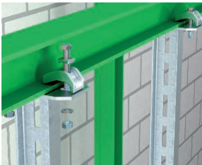
Direkte Stahlklemmung Direkte Stahlklemmung eines I-Hängestiels mit Spannklau (schwer) Typ TKS-S-30. Trassenverlauf längs zum Stahlträger.
