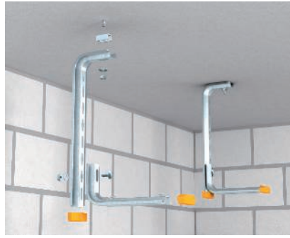
Montage TP-Hängestiel mit einseitiger Auslegerbefestigung Deckenmontage eines TP-Hängestiels mit Distanzstück DS 4 und einseitiger Auslegermontage. Maximale Trassenbreite 300 mm.
