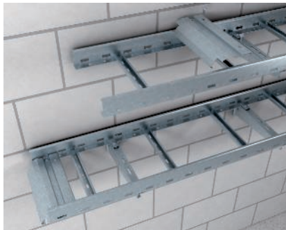
Kabelabgang vertikal Bei vertikal abgehenden Kabeln oder Leitungen kommt das Abgangsblech Typ LAB zur Vergrößerung der Kabelauflage und als Kabelschutz zum Einsatz.
