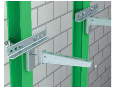
Klemmbefestigung an senkrechtem Stahlträger Montage der Adapterplatte Typ KA-AW an senkrechtem Stahlträger mit Klemmwinkeln oder Spannpratzen. An der Adapterplatte werden Wandausleger Typ AW mit der Sechskantschraube Typ SKS 12x40 GF befestigt.
