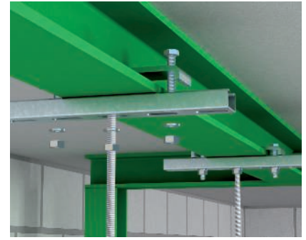
Stahlklemmung C-Profilschiene Befestigung eines C-Profils Typ MS 4022 oder MS 5030 an Stahlträger mit Klemmwinkeln Typ KWS.
