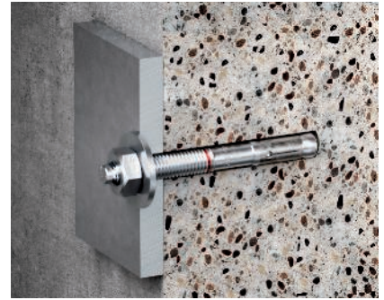
Bolzenanker Typ BZ Bolzenanker Typ BZ, zur Befestigung von Schwerlastverankerungen in gerissenem oder ungerissenem Normalbeton C20/25 bis C50/60, für Durchsteckmontage geeignet, mit Anschlussgewinde M8, M10, M12 oder M16.
