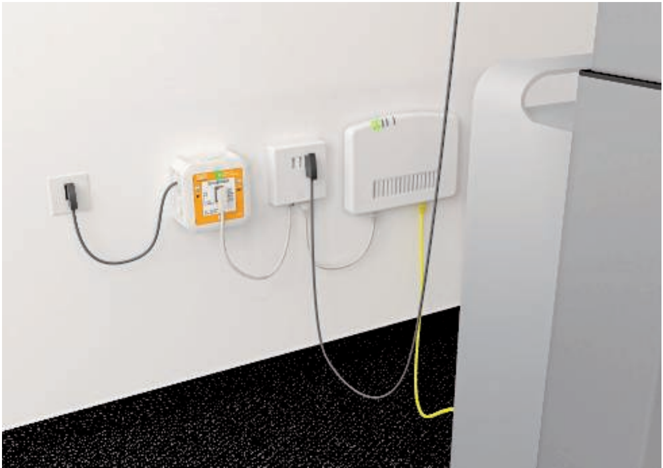
Schutz eines ISDN- + DSL-Anschlusses mittels TeleDefender
