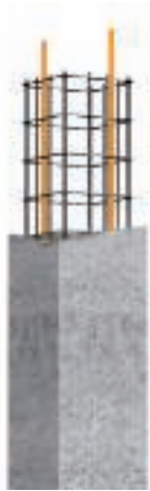
Beispiel: Nutzung von bewehrten Betonstützen/Ableitungseinrichtung
