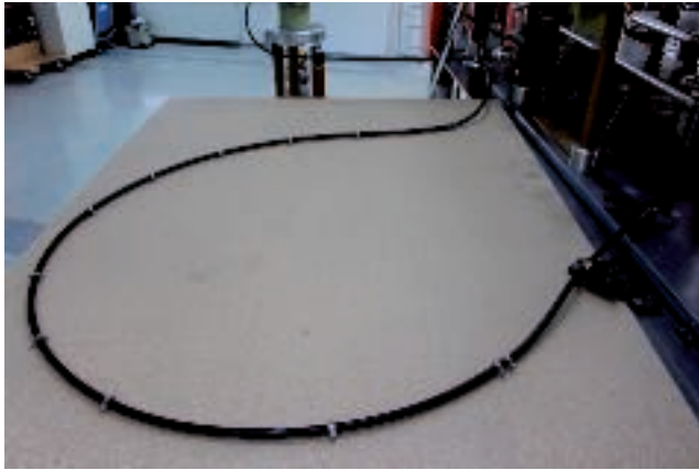
Aufbau zur Prüfung der Blitzstromtragfähigkeit einer isolierten Ableitung z. B. mit 200 kA
