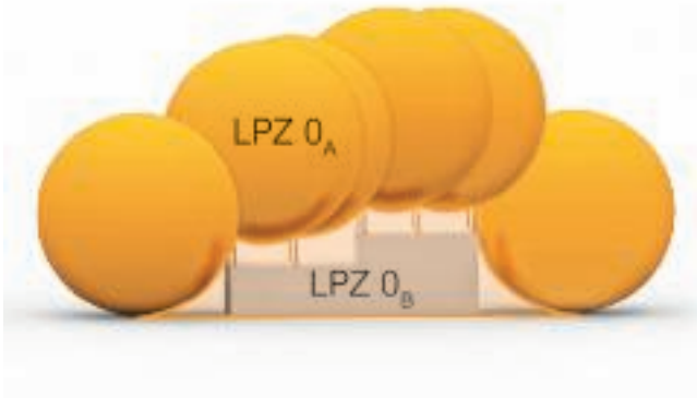
Blitzkugelverfahren und resultierende Blitzschutzzonen (LPZ)
